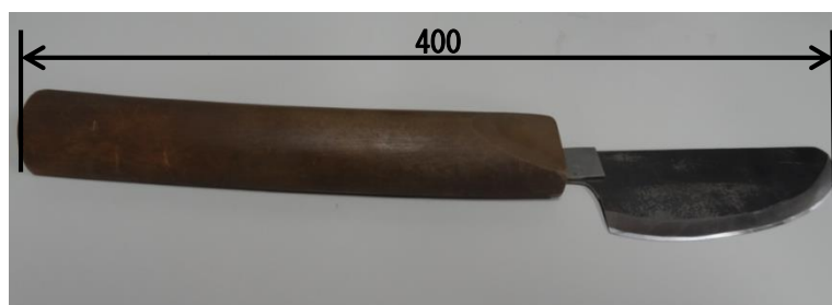
図 1.1 職人が使用している刃（単位[mm]）
