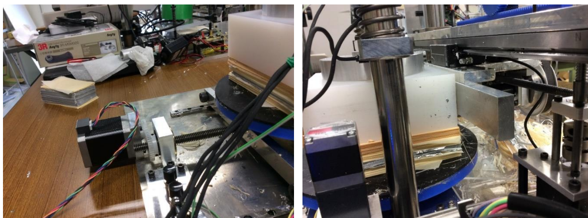
図 3.3 箱固定ブロックのガイド(刃)への押し付け
