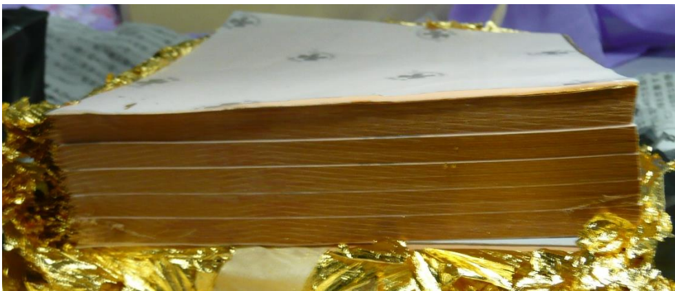
図 4.7 金箔と和紙の積層体の切断面
