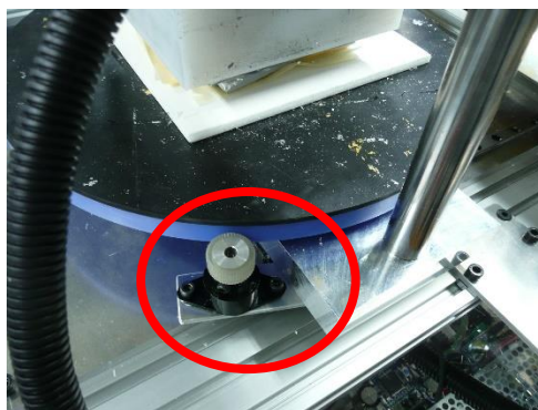
図 3.8 箔固定部（ターンテーブル）の回転を抑制するローラダンパ
