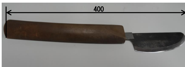
図 1.1 職人が使用している刃（単位[mm]）
