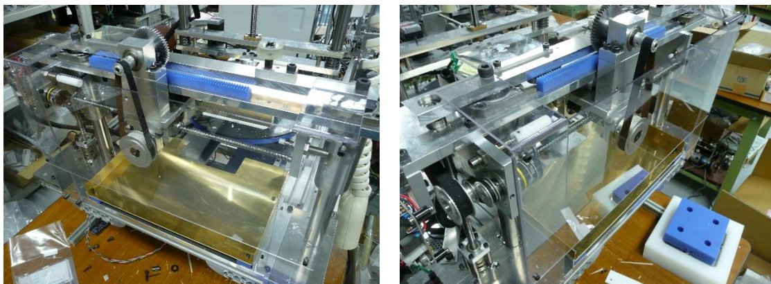
図 3.16 刃の移動部の安全カバー
