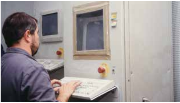
1 コンピュータで箔打機を制御する (ゲルステンドルファー、ドイツ) 1 A hammering machine is operated by computer. (Gerstendörfer, Germany)
