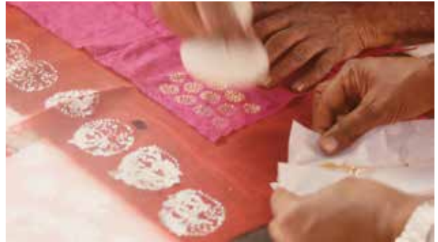
5 糊置きしてから金箔を置き上から綿パッドで押さえる (アジメール) 5 Placing the gold leaves on to a glued fabric and pressing them with a cotton pad. (Ajmer)
