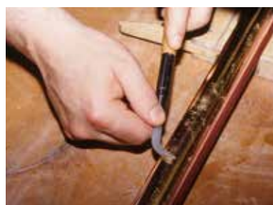
7 ポリメントの仕上げ: メノウ棒で額縁の棹 を磨く(パリ) 7 Poliment finish: burnishing the frames with an agate stone burnisher. (Paris)
