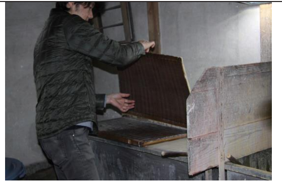
写真 18-2: 箔打紙の紙すき作業①
