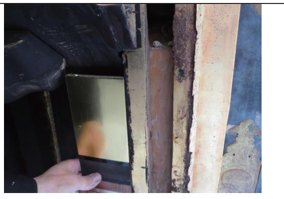
写真 19-2:同 寛永期金箔と現代の金箔の色相比較(左:金沢三号色(縁付箔)の漆箔手板と右:試料 1)
