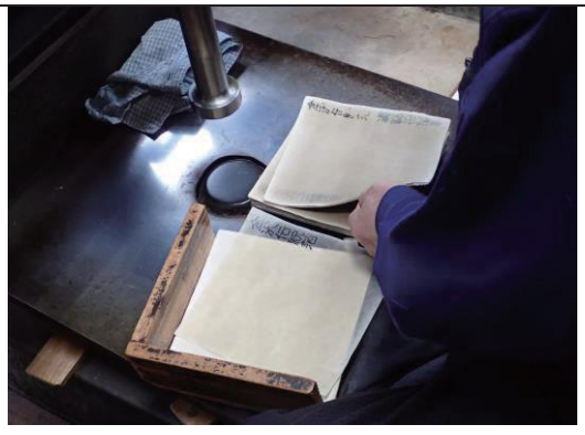
写真 18-4: 金箔箔打紙の作製
