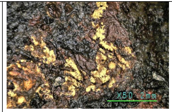
写真 9-2 : 同 漆箔金箔の拡大観察
