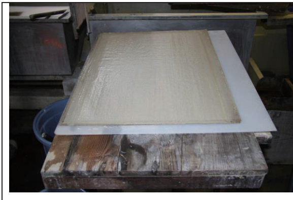
写真 18-3:箔打紙の紙すき作業②
