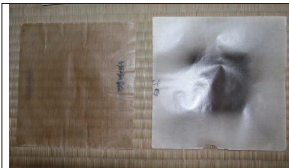
写真 18-5:箔打ち用の和紙(箔紙)の状態
