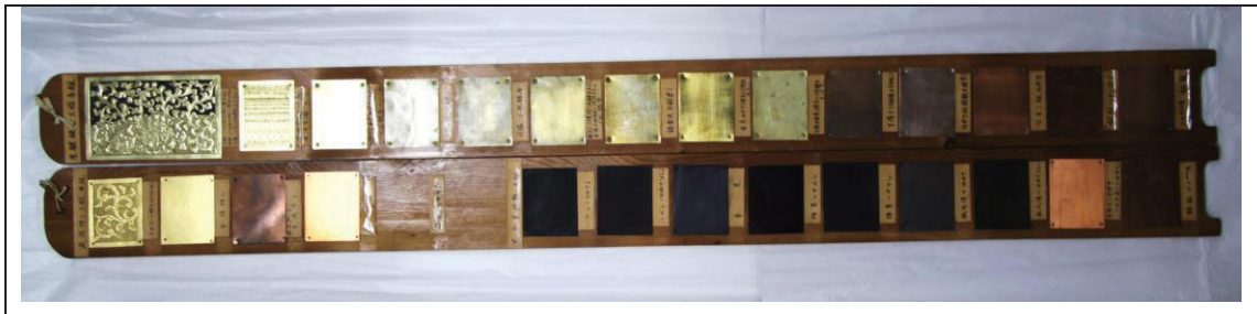
写真 16: 日光東照宮建造物における金具鍍金の伝統技術復元手板資料(全体)
