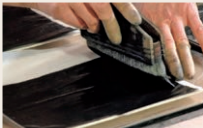
工場生産のグラシン紙に、カーボン（油脂の煤）、アルミ粉、ミルクカゼイン、界面活性剤の溶液を塗布する。
